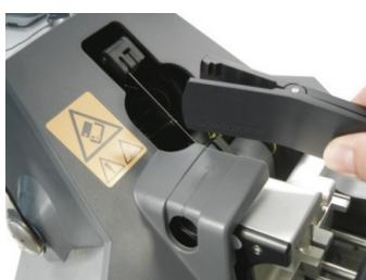
2. Presione la herramienta extractora de cuchillas sobre la cuchilla.
