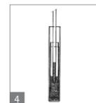
4. Au moyen d'une pipette, retirer le filtrat (Fig. 4) dès la fin de la centrifugation (le filtrat se diffusera lentement dans le concentrat).
