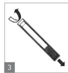
3. In einer Laborzentrifuge für maximal 17 × 100 mm Röhrchen (Abb. 3) zentrifugieren. Maximale relative Zentrifugalbeschleunigung: 2.500 g bei Ausschwingrotoren, 2.000 g bei Winkelrotoren (siehe Diagramm). Bei konzentrierten Proteinlösungen, z.B. Serum oder Blut, zu Beginn 5 Minuten bei halber Maximaldrehzahl zentrifugieren. Bei lipoidhaltigen Lösungen, z.B. Milch, nur mit Winkelkopprotoren zentrifugieren.
