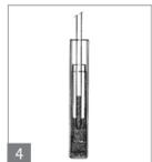
4. Estrarre il filtrato con una pipetta (Fig. 4) il prima possibile dopo il completamento della centrifugazione (il filtrato tornerà a diffondersi lentamente nel concentrato).
