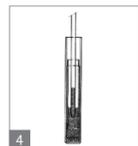
4. Pipetee el filtrado (fig. 4) tan pronto como sea posible una vez haya finalizado la centrifugación, pues este volverá a difundirse lentamente en el concentrado.
