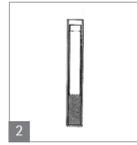
2. Schwimmer mit Membran nach unten wieder in das Zentrifugenröhrchen hineingleiten und ca. 5 Minuten stehen lassen, so dass die Membran von der Probe benetzt wird (Abb. 2). Ausnahme: bei Filtration von nicht koaguliertem Blut vor dem Einführen des Schwimmers ca. 2 Minuten vorzentrifugieren, um Hämolyse zu vermeiden. Für die Zentrifugation Verschlusskappe nicht wieder aufsetzen.
