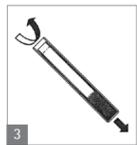
3. Centrifugare in una centrifuga da laboratorio che possa contenere fino a 17 provette da 100 mm (Fig. 3). Forza centrifuga relativa massima: 2.500 g con rotori oscillanti, 2.000 g con rotori angolari (vedere grafico). Quando si filtrano soluzioni proteiche concentrate, ad esempio siero o sangue, iniziare con 5 minuti di centrifugazione a una velocità pari alla metà dei g/min. massimi. Quando si filtrano soluzioni contenenti lipidi come il latte, usare solo un rotore angolare.
