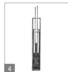
4. Filtrat möglichst bald nach Beendigung der Filtration herauspipettieren (Abb. 4), sonst Gefahr der Rückdiffusion.
