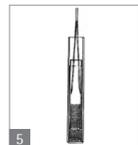
5. O retire el tubo flotante con unas pinzas abiertas para tener acceso al concentrado (fig. 5).
