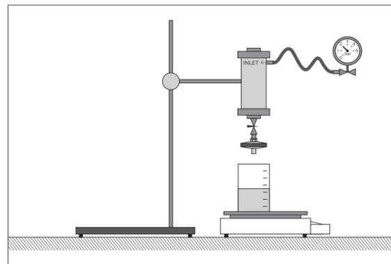
Typischer Filtrationsaufbau für einen Virosart® CPV Minisart®
