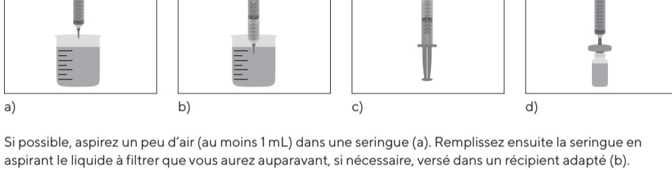
Si possible, aspirez un peu d'air (au moins 1 mL) dans une seringue (a). Remplissez ensuite la seringue en aspirant le liquide à filtrer que vous aurez auparavant, si nécessaire, versé dans un récipient adapté (b).
