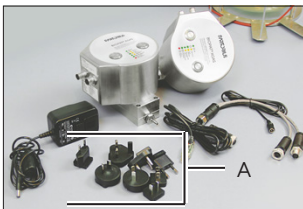
Abb. 4: Analysegerät, Signalkabel und Zubehör zum Netzanschluss (A) Ersatzteilkit 1: SB-20-02-0002, Netzteil für BioPAT® Xgas
