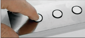
Abb. 4h: Hineindrücken des Filters
