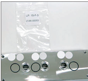
Abb. 4d: Filter und Dichtungen
