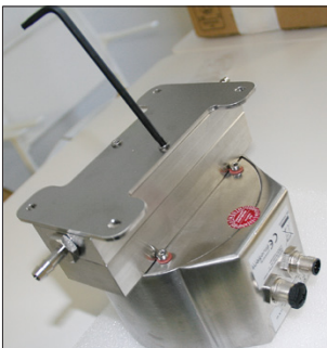
Abb. 4k: Grundplatte anbringen
