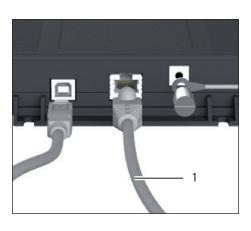
► Connect the equipotential bonding cable to the customer-supplied equipotential bonding conductor.
