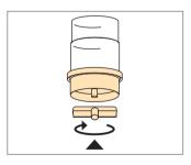
Verschließen der Sterisart<sup>®</sup> NF Behälter ausgangsseitig mit jeweils beiliegendem Flügelstopfen (fest mittels einer Rechtsdrehung aufsetzen).
