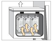
Sterilisation des Äußeren der Kunststoffschachtel gemäß Isolator Validierung, z.B. mit  $\rm H_2O_2$ .
