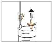
Entfernen der Gummikappen von den Luftfiltern.
