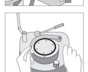
Einlegen des Sterisart<sup>®</sup> NF Schlauchsystems in den Pumpenkopf (bitte Bedienungsanleitung der Pumpe beachten).
