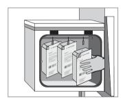
Öffnen der gasundurchlässigen Kunststoffschachteln oder gegebenenfalls Einschleusen der einzeln-verpackten geschlossenen Sterisart\* NF Systeme in den Isolator.
