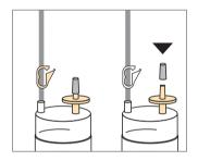
Festes Verschließen der zwei Luftfilter mit den beiliegenden Gummikappen.
