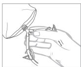
Durch das Anschalten der Pumpe wird die Probe gleichmäßig auf die beiden Sterisart\* NF Behälter überführt, gleichzeitig zieht sich der Kunststoffbeutel durch sich im Inneren des Beutels aufbauenden Unterdruck zusammen.
