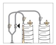
Nährmedium 1 (Thioglycolat-Medium): Schließen der weißen Schlauchklemme am Ausgang des Y-Verteilerstücks.
