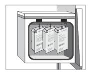
Einbringen der einzelnen, in gasundurchlässigen Kunststoffschachteln, verpackten Sterisart\* NF Systeme in den Sterilisationsbereich.
