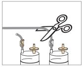
Abklemmen beider Schläuche oberhalb der Sterisart<sup>®</sup> NF-Behälter mittels vormontierter Schlauchklemmen. Abschneiden der Schläuche.
