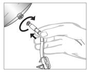
Luer Lock weiblich Anschluss (abnehmbarer Adapter) des Sterisart® NF Systems durch Drehung im Uhrzeigersinn an den Kunststoffbeutel mit Luer Lock männlich Anschluss anschließen.
