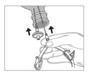
Mit 6-cm Metallnadel und geschlossenen Mediumbehälter: Einstechen der Metallnadel sowie der Belüftungsfilterkanüle in den Verschluss des Behälters.
