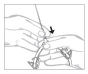
Aufsetzen der beigefügten 6-cm Metallnadel auf den Y-Verteiler zur Entnahme der Waschlösung aus offenen Gefäßen.
