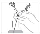
Mit 6-cm Metallnadel aus offenen Mediumbehältern: Entnahme des Mediums über die Metallnadel.
