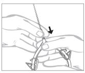
Aufsetzen der beigefügten 6-cm Metallnadel auf den Luer männlich Anschluss des Y-Verteilerstückes (Probenehmer) zur Entnahme der Waschlösung aus offenen Gefäßen.
