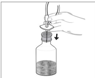
Unmarkierte Metall-Doppelnadel (kürzere der beiden Metall-Doppelnadeln) so weit wie nötig in das aufrecht stehende mit schwerlöslichem Pulver gefüllte Behältnis stechen.
