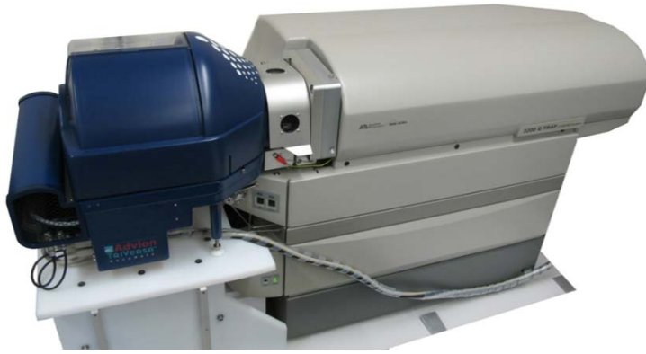
Fig. 2 : Système HPLC/nano-ESI-MS/MS pour l'analyse des jasmonates. Un appareil 3200 hybride triple quadropolaire/linéaire à trappe d'ions de la société Applied Biosystems sert de spectromètre de masse. L'ionisation par nano-électrospray (nanoESI) est assurée par la source d'ions basée sur une puce TriVersa NanoMate (Advion BioSciences). Le système HPLC d'Agilent n'est pas représenté. (photo : département de biochimie végétale, Albrecht-von-Haller-Institut, Georg-August-Universität, Goettingen, Allemagne)
